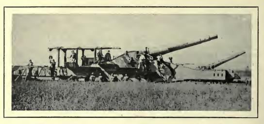
SHOWING HOW THE 16-IN. GUNS ARE FIRED FROM A RAILWAY.
